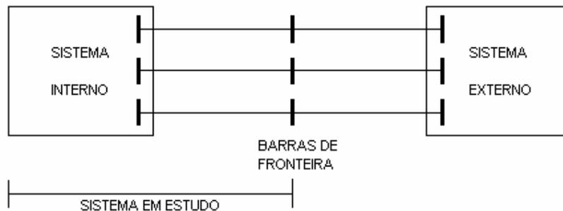
Figura 1.1 - Divisão do sistema elétrico para o cálculo de equivalentes dinâmicos.
