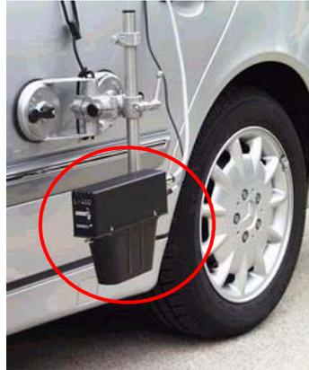
Figura 2.4: Transdutor longitudinal montado na lateral de um veículo.
