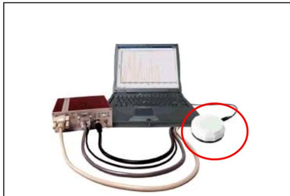
Figura 2.9: Equipamento com transdutor GPS.
