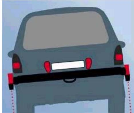
Figura 2.5: Esquema de montagem de dois transdutores para a medição de altura.
