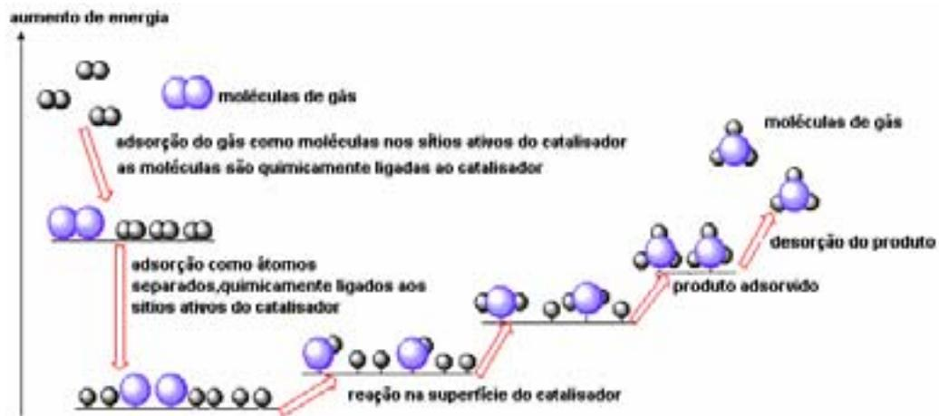
**Figura 2:** Esquema do processo de reação da síntese de amônia [11].
