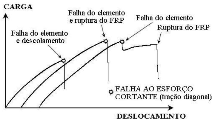
Figura 2.59 – Gráfico carga x deslocamento (adaptada de Triantafyllou e Antonopoulos, 2000).
