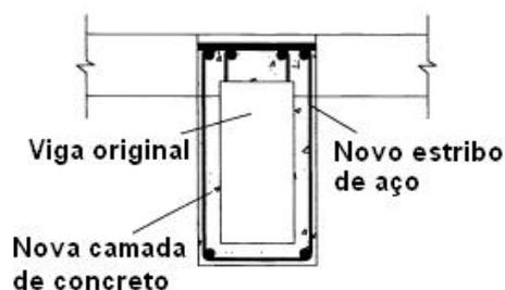
Figura 2.44 – Aumento da seção transversal (adaptado de Täljsten, 2003).
