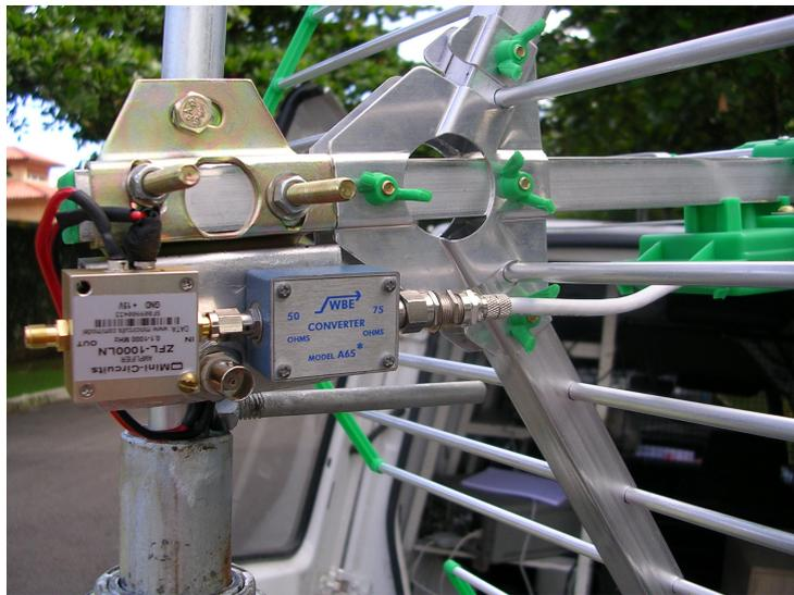
Figura 19: Fixação do Casador 75/50  $\Omega$  e do LNA junto a antena
