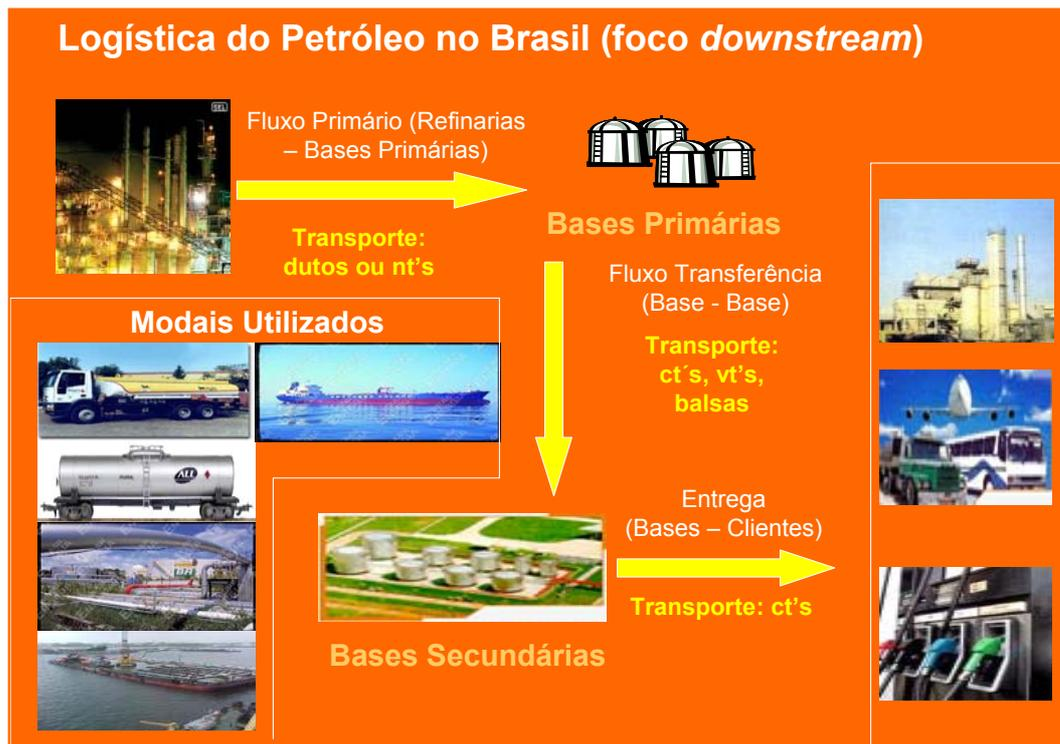
Figura 4: Esquema de Distribuição de Petróleo e Derivados no Brasil
