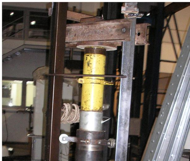
Figura 3.21 – Posicionamento do macaco hidráulico para a realização de ensaios estáticos.
