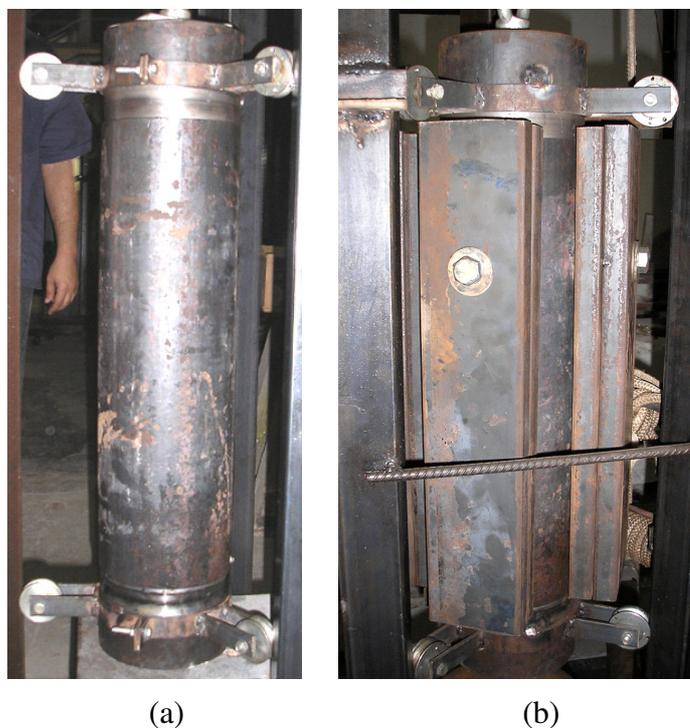
Figura 3.17 – Martelo de impacto: a) massa de 100 kg; b) massa de 180 kg.
