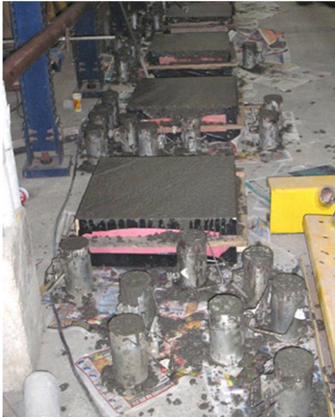
Figura 3.10 – Blocos após a 1ª concretagem (1ª e 2ª betonadas).
