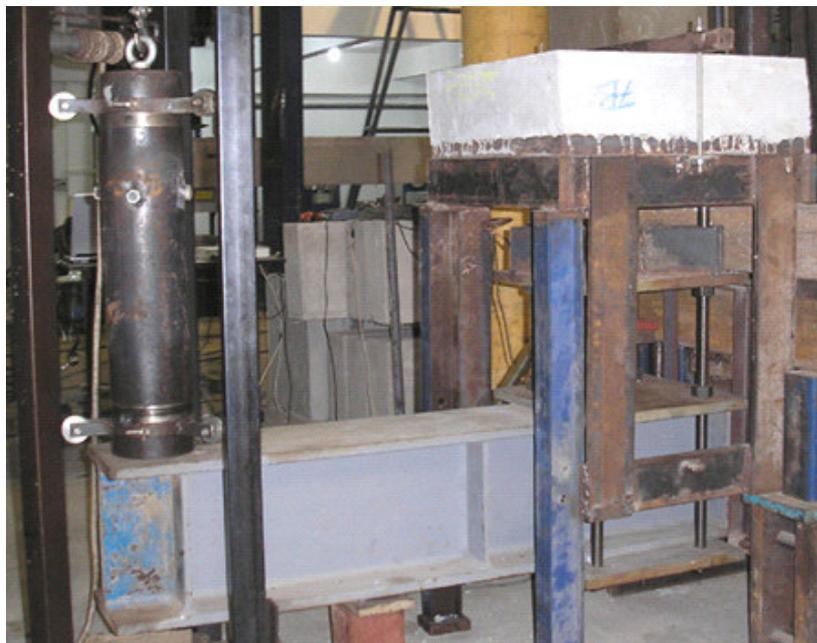
Figura 3.27 – Arranjo experimental para ensaios dos blocos B22W100H220.
