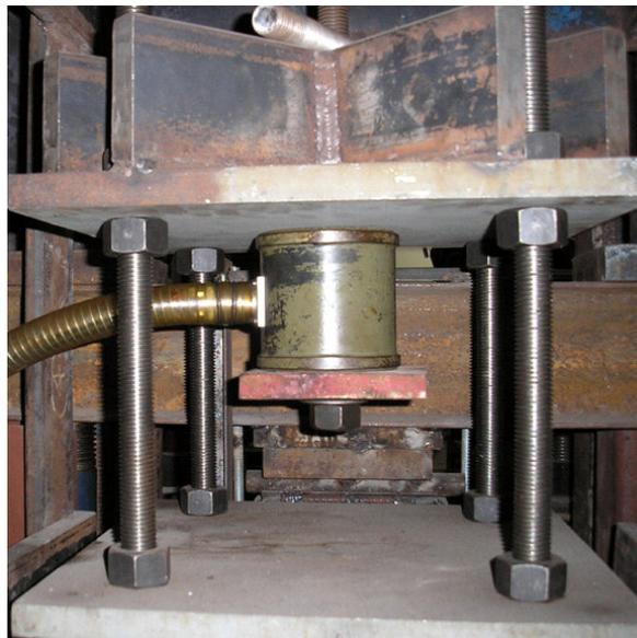
Figura 3.13 – Posicionamento da célula de carga.
