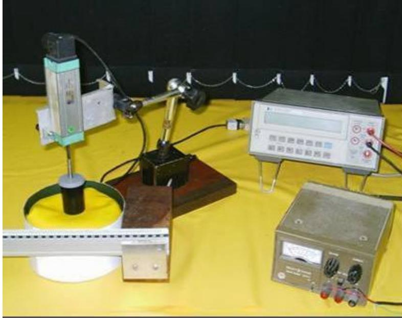
Figura 4.18 – Ensaio de compressão da base elástica
