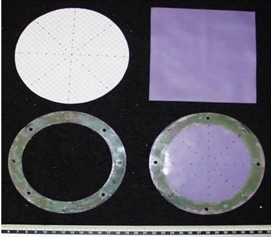
Figura 4.3 – Anéis de acrílico onde eram fixadas as membranas de borracha
