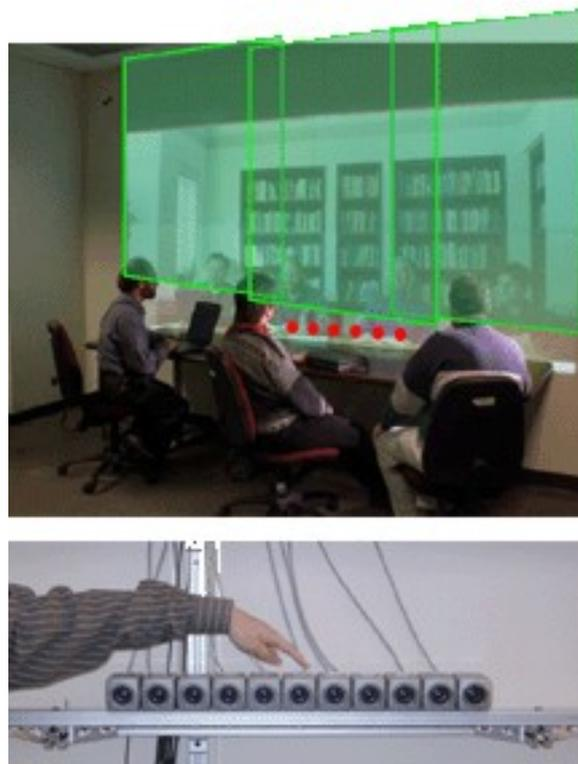
Figura 2.10: Telas de exibição e um conjunto horizontal de câmeras
