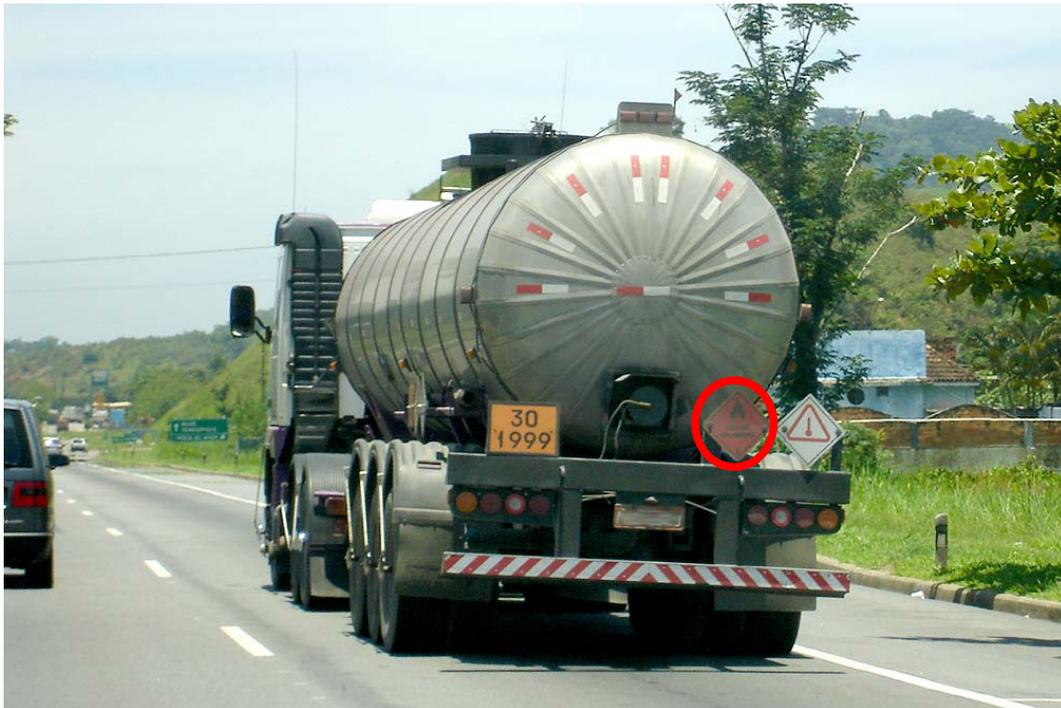
Figura 2-19 – Caminhão-tanque com painel de segurança, rótulo de risco destacado (líquido inflamável) e placa especial (significando transporte a temperatura elevada) (Fonte: a autora).
