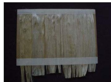
Figura 54 – Modelo experimental: disposição dos feixes de fibras de juta.
