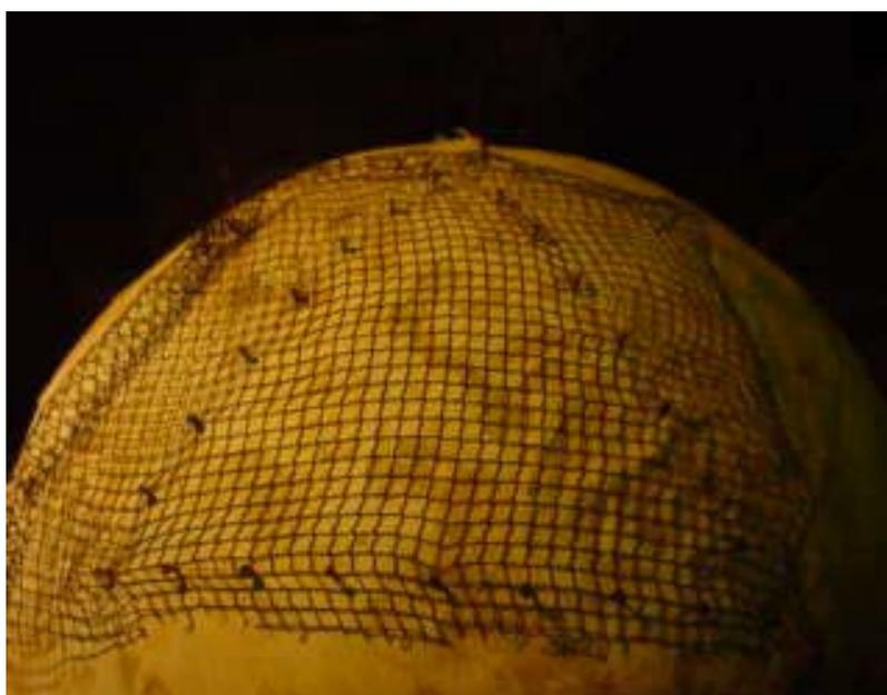
Figura 66 – Verificação das deformações de uma rede de trama ortogonal em superfície esférica.
