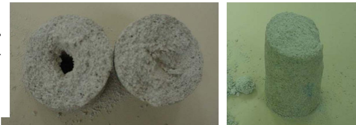
Figura 4.08 – Corpo de prova 4C após o ensaio. Nota-se o preenchimento de praticamente toda a cavidade interna.
