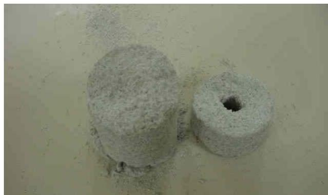
Figura 4.29 – Corpo de prova 10B após o ensaio. Nota-se o preenchimento de praticamente toda a cavidade interna.
