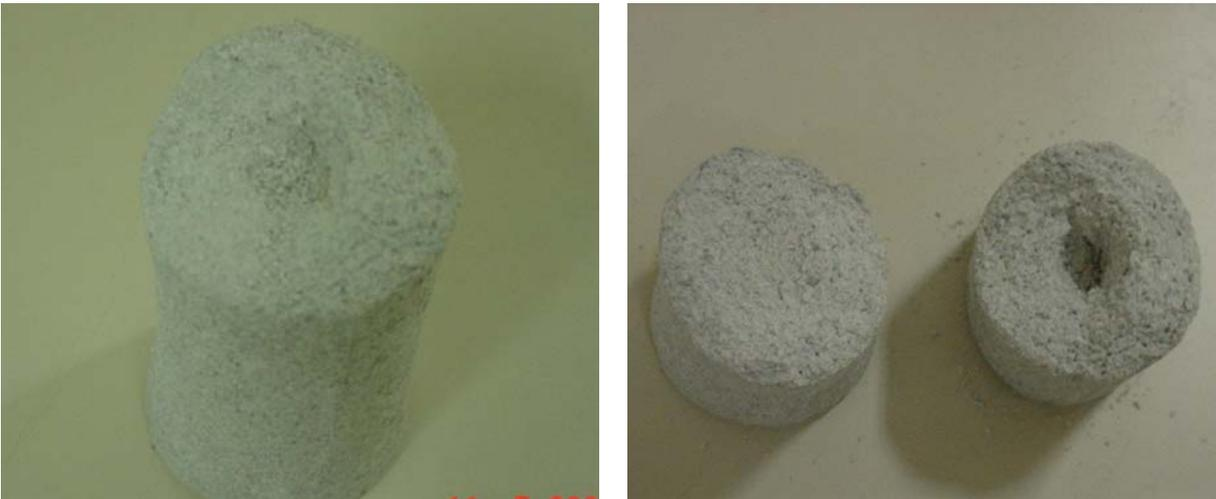
Figura 4.36 – Corpo de prova 8B após o ensaio. Nota-se o preenchimento de praticamente toda a cavidade interna.
