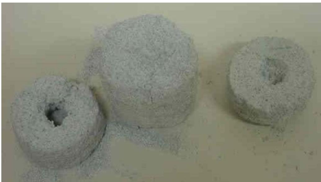
Figura 4.22 – Corpo de prova 9 após o ensaio. Nota-se o preenchimento de praticamente toda a cavidade interna.
